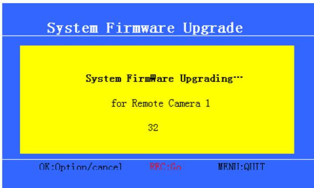
Während der Aktualisierung wird ein Countdown auf dem Bildschirm gezählt - jeweils für die Kameras und dem Monitor. Während der Aktualisierung wird zuerst die Software übertragen (Das LED Licht der Kamera blinkt). Nach der Übertragung wird die Software in den Speicher geschrieben. Während diesem Vorgang blinkt das LED Licht schnell. Sobald die Software komplett aufgespielt ist, erlischt das LED-Licht.
